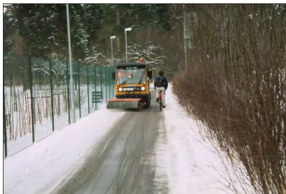
Bild 6. Borstning och spridning av saltlösning på en gång- och cykelväg i Linköping (Foto: GCM-handboken).
